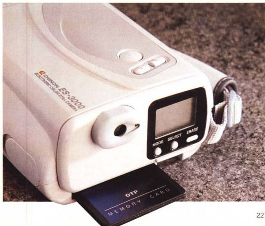
Utilizzando schede di memoria PCMCIA è possibile aumentare all'infinito le capacità di memorizzazione.
